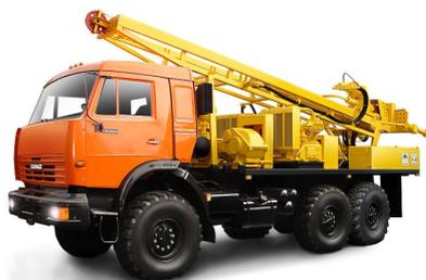
Установка буровая самоходная УРБ-2А-2С «СТРЕЛА» на шасси КАМАЗ-5350 (ЕВРО 4) предназначена для бурения геофизических и структурно-поисковых скважин на нефть и газ, разведки месторождений твердых полезных ископаемых, строительных материалов и подземных вод, инженерно-геологических изысканий, бурения водозаборных и взрывных скважин. Процесс забуривания может осуществляться шнековым, шарошечным, колонковым, пневмоударным и ударно-канатным способами.
