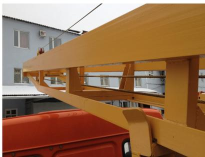
Мачта буровой установки имеет «П»-образную конструкцию с одной открытой гранью из стандартного высококачественного профиля с повышенным сопротивлением кручению и изгибу. Конструкция может быть выполнена в удлиненном варианте для работы с бурильными трубами длиной 6,2 метра, что позволяет снизить время спускоподъемных операций и тем самым увеличить скорость бурения (изготавливается только под экспорт).
