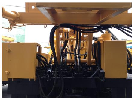
Буровая установка гидрофицирована, все спускоподъемные операции производятся с пульта управления бурильщика. В конструкции гидравлической системы установлено разгрузочное устройство, снижающее нагрузку на резьбу при свинчивании-развинчивании бурильных труб. Давление в гидросистеме не превышает  $125 \text{ кгс/см}^2$ , что способствует снижению нагрузок на гидравлические элементы и по-
