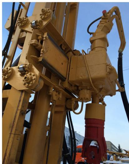
Сдвигаемый вращатель (сдвиг на 420 мм) обеспечивает проведение в скважине различных работ - бурения, опробования, исследования. Совместно с лебедкой позволяет бурить комплексами ССК типоразмеров ВQ (с коронкой диаметром 60/36,5 мм), NQ (75,8/47,6 мм) и HQ (96/63,5 мм). Вращатель имеет оригинальную конструкцию, обеспечивающую повышенные пара-
