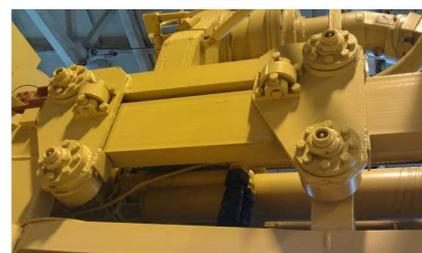
Каретка оригинальной конструкции служит для обеспечения подвижности вращателя относительно мачты и передачи действующих нагрузок от вращателя и бурового инструмента на мачту. Применение эксцентриковых осей роликов каретки позволило обеспечить более жесткое и точное центрирование шпинделя вращателя относительно оси Рабочего стола мачты и скважины.
