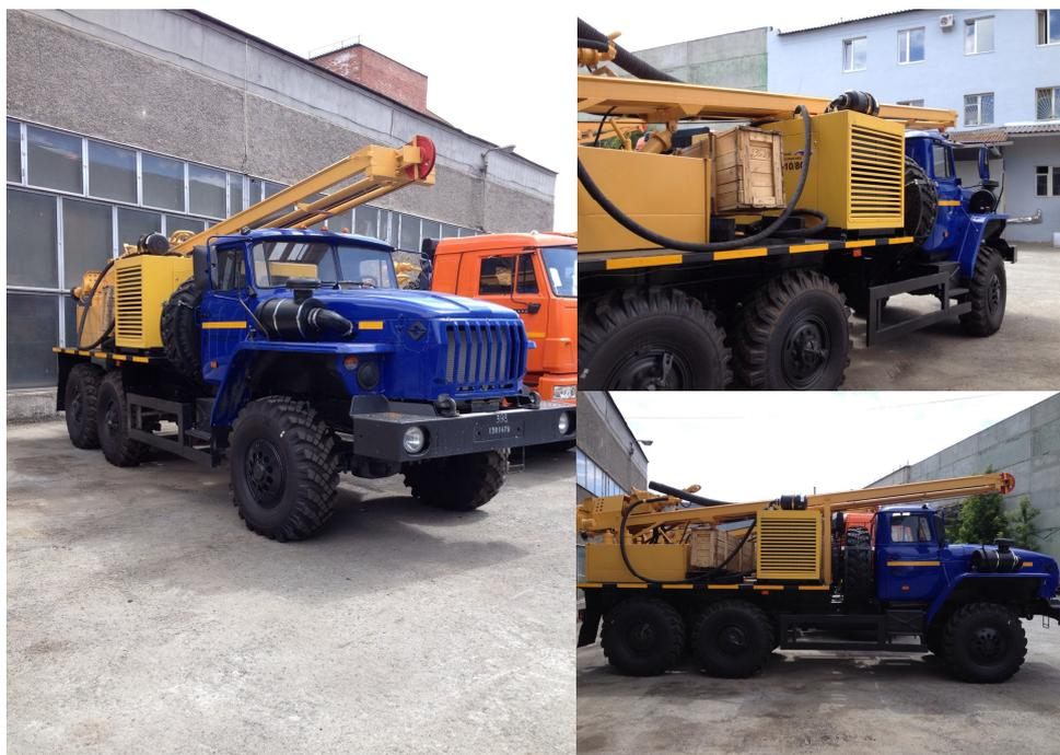
**Буровая установка УРБ-2А-2 предназначена главным образом для бурения геофизических и структурно-поисковых скважин на нефть и газ, разведки месторождений твердых полезных ископаемых, строительных материалов и подземных вод, инженерно-геологических изысканий, бурения водозаборных и взрывных скважин.**
